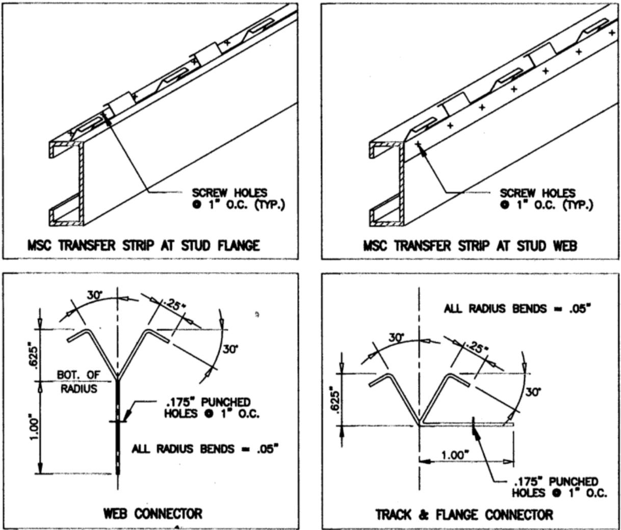
FIGURE 2—MetalStudCrete CONNECTOR
